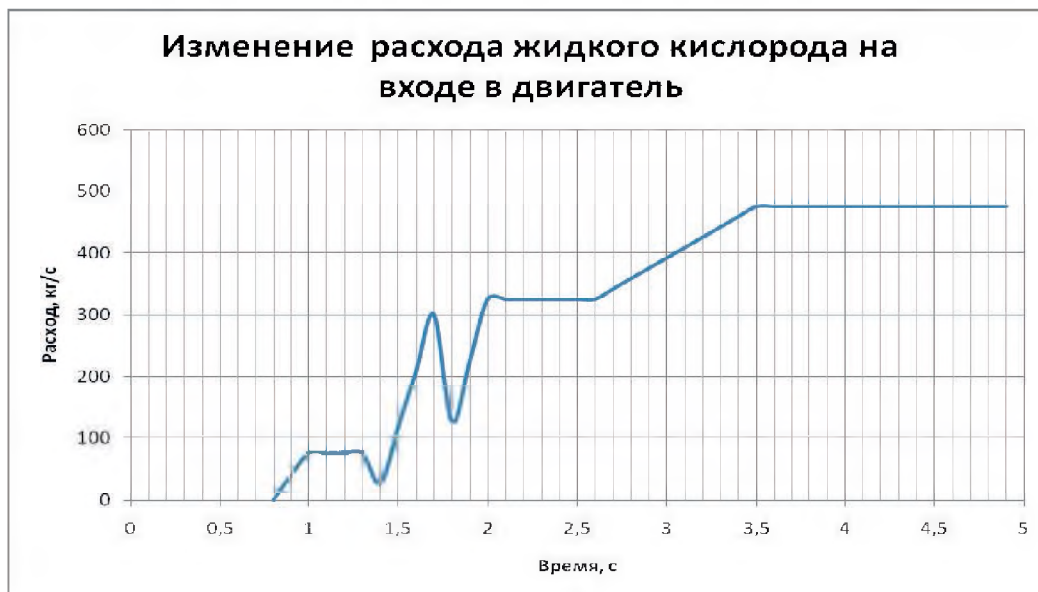
Рис. 4. Расход компонента топлива на входе в двигатель
