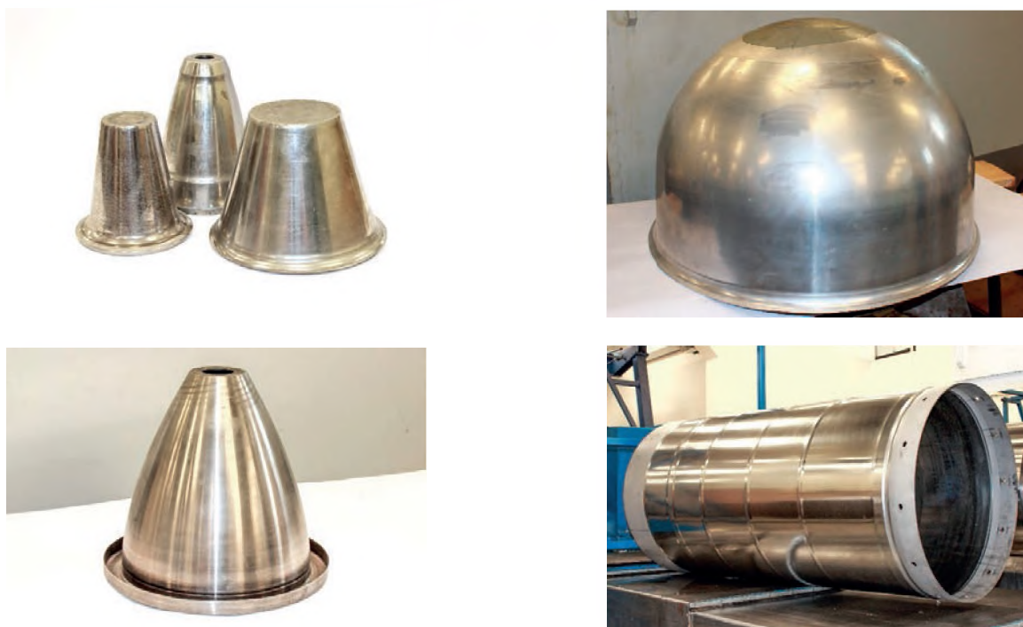
Рис. 2. Детали, изготовленные ротационной вытяжкой [1]
