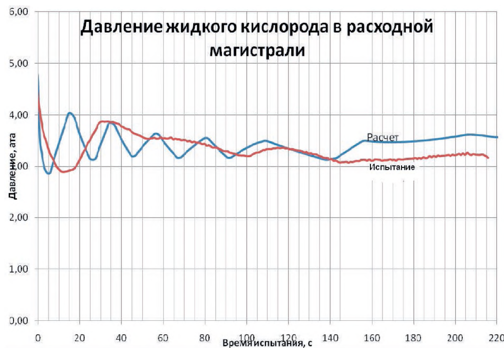
Рис. 5. Сравнительные данные по давлению перед двигателем
